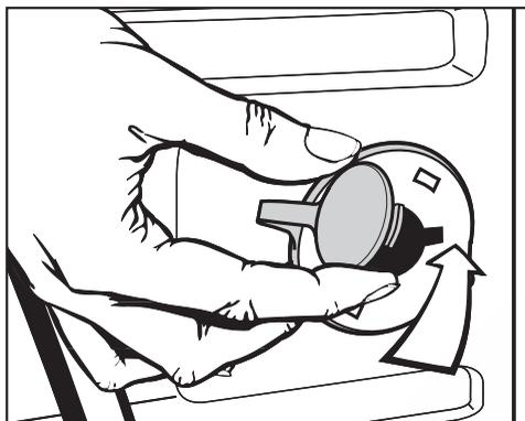
**⚠** Стиральную машину нельзя перевозить без транспортировочного крепления. Сохраняйте крепление. Его необходимо будет опять смонтировать перед транспортировкой стиральной машины (например, при переезде).
