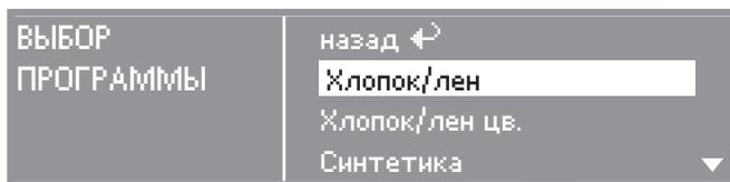
С помощью многофункционального переключателя Вы можете выбрать имеющиеся программы. Значок выделения смещается вверх или вниз в зависимости от направления вращения ручки многофункционального переключателя. Стрелки ▼▲ на дисплее справа указывают, имеются ли еще возможности выбора. При нажатии ручки многофункционального переключателя открывается основное меню выбранной программы стирки.
