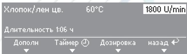
Вращая ручку многофункционального переключателя, можно выбрать различные компоненты программ, программу, температуру и число оборотов барабана при отжиме. Выбранный компонент выделяется. При нажатии ручки многофункционального переключателя компонент выбирается, и открывается соответствующее подменю.
